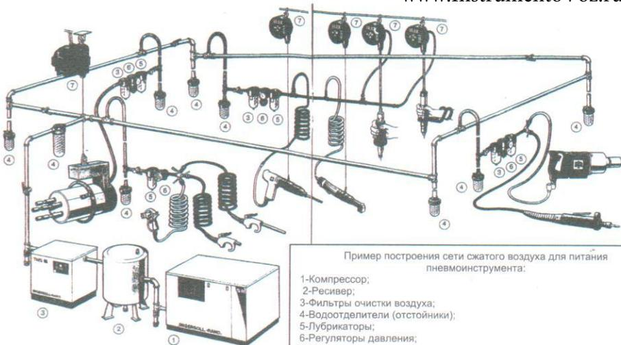
Пример построения сети сжатого воздуха для питания пневмоинструмента:
