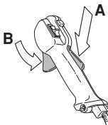
Проверьте, чтобы ручка газа в момент возвращения блокировочного рычага в исходное положение была блокирована на холостом ходу.
