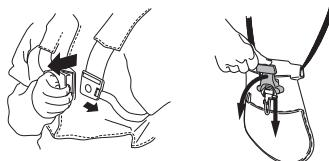
Удостоверьтесь, что привязные ремни оснастки были правильно расположены. Когда машина будет отрегулирована, проверьте работу системы быстрого отстегивания оснастки.
