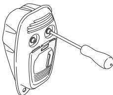
Если глушитель на вашей машине дополнительно оборудован искрогасящим фильтром, его следует регулярно прочищать. Забившийся фильтр может вызвать перегрев
