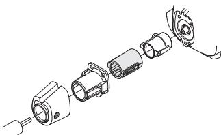
Регулярно проверяйте, чтобы на виброгасящих элементах не было трещин или деформаций.
