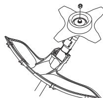
При сборке надо затягивать гайку против направления вращения режущего оборудования. При разборке надо отвинчивать гайку в направлении вращения режущего оборудования.
